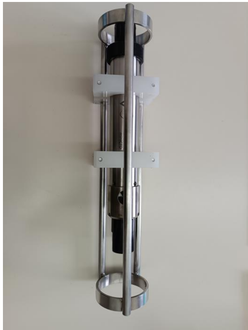
Εικόνα 2: Το Valeport MiniCTD που χρησιμοποιήθηκε για τις μετρήσεις θερμοκρασίας και αλατότητας.
