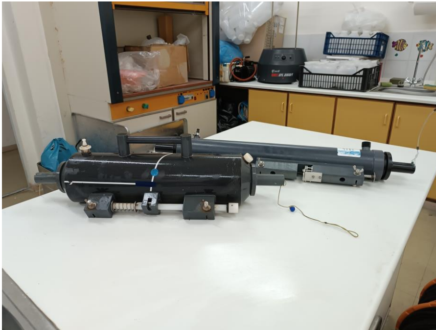
Εικόνα 4: Δειγματοληπτικές φιάλες NISKIN, χωρητικότητας 2 και 5 l.
